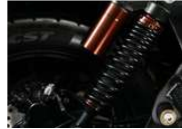
Dahili nitrojen ön yüklemeli, ayarlanabilir sönümlleme
