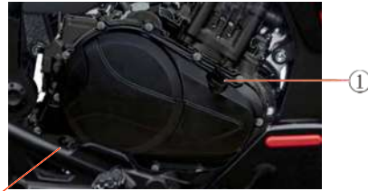
① Yağ dolum kapağı ② Yağ göstergesi
